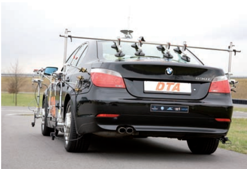
Bild 1: Außenansicht der am Fahrzeug installierten Messtechnik
